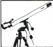
60mm Fraunhofer-Refraktor, 900mm Brennweite, 6x30 Sucher, Zenitspiegel, 25mm und 9mm MA-Okulare 1 1/4", parallaktische Montierung mit biegsamen Wellen, höhenverstellbares Dreibeinstativ aus Holz.
