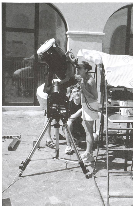
Fig. 10. Ein 10" LX 200 von Meade mit H alpha Filter und CCD-Kamera (ESA-Material).
