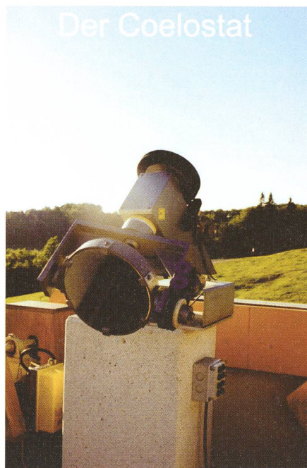
Fig. 4: Coelostat zur Sonnenbeobachtung.
