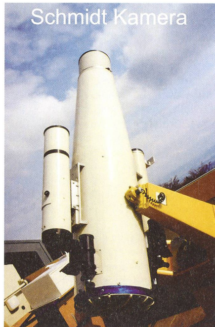
Fig. 10: Schmidt-Kamera, Brennweite 1000mm, Spieldurchmesser 400mm, Öffnung 300mm.
