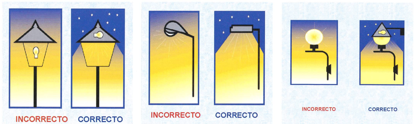
Luminaires: les mauvais et les bons...
