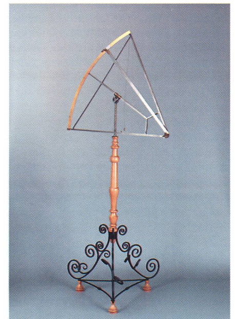
Bild 6: Jost BÜRGI, Astronomischer Sextant, Rekonstruktion (Museum für Astronomie und Technikgeschichte Kassel)
