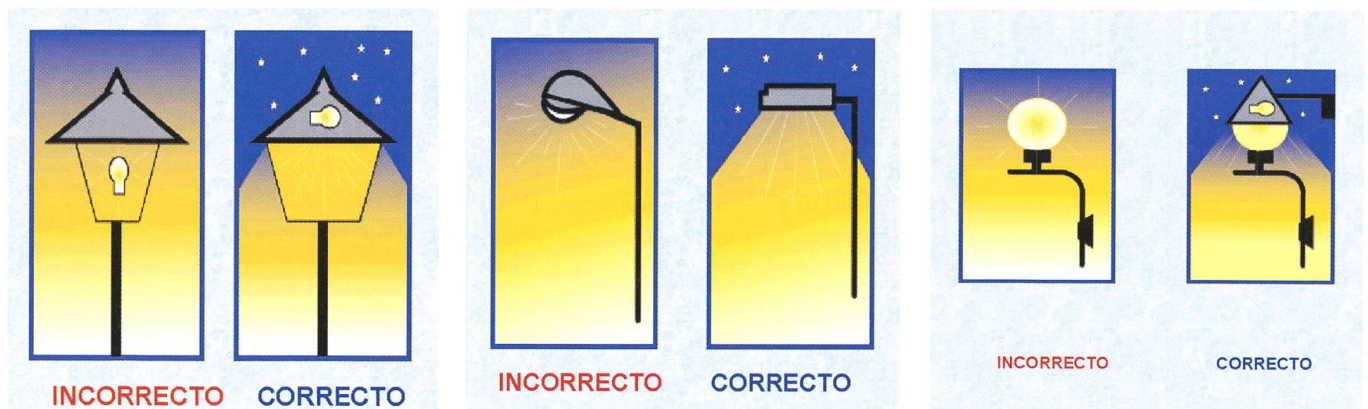
Luminaires: les mauvais et les bons...
