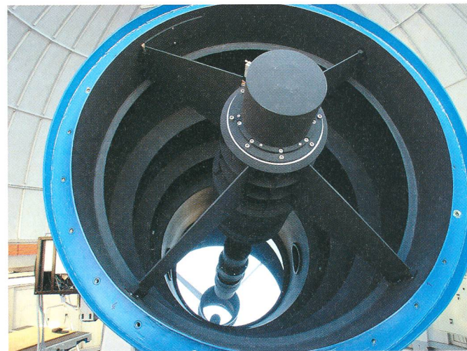
5. Le miroir de 1.2m du télescope Mercator.
