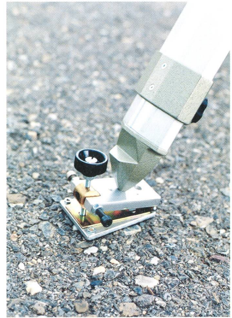
Fig. 2: L'équerre pour le réglage fin en altitude.
