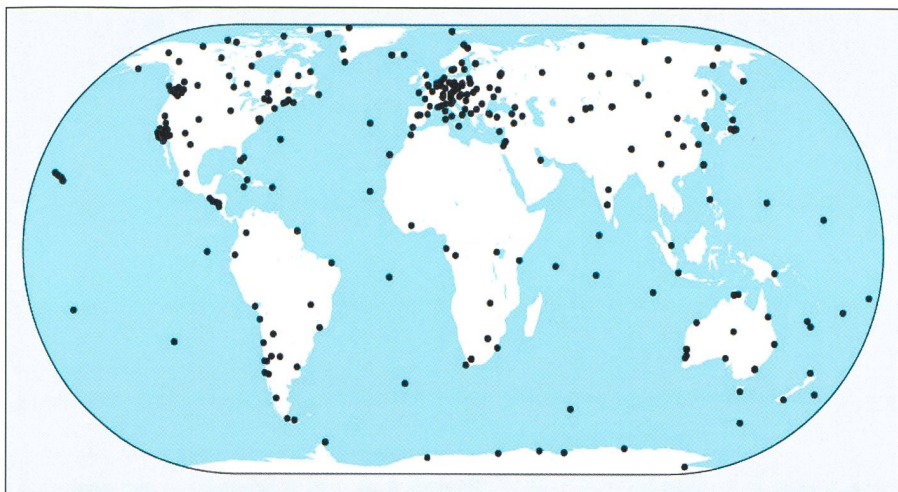
Figur 4: Permanentes GPS-Messnetz des IGS (International GPS Service) bestehend aus über 350 Empfängern.
