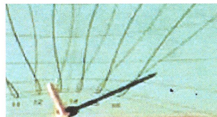
Fig. 2: Modell einer Analemma- Sonnenuhr. Vordergründig sieht man den Gnomon seinen Schatten auf die Bildebene werfen. In der Bildebene liegen die Stundenanalemmen 11 bis 16 Uhr MESZ. Von links nach rechts verlaufen die Monatshyperbeln (Von unten nach oben: Juni, Mai/ Juli, April/ August, März/ September, Februar/ Oktober und am oberen Bildrand noch Januar/ November). Die Hyperbel März/ September ist eine Gerade (20./21. März, 22./23. September). Es ist Tagundnachtgleiche, Äquinoktium, Jahreszeitwechsel (Winter/ Frühling, Sommer/ Herbst), die Sonne steht senkrecht über dem Äquator. Vom Gnomon Richtung oberer Bildrand läuft die Gerade nach Nord – der Gnomon steht im Süden. Abgelesene Zeit: Bildverzerrung. ca. 4./5. April 16:10/12 UHR 6./7. September.
