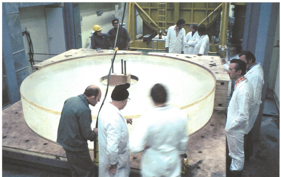
Fig. 13. Le miroir principal de 3m60 est sorti de sa caisse pour être préparé au montage dans le télescope (septembre 1976). Le miroir, classique et massif, avait été taillé presque 10 ans auparavant dans les ateliers REOSC en France. L'optique s'avéra être excellente.
