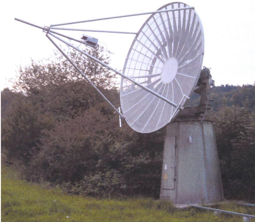
Fig. 1: 5m-Parabolspiegel automatisch positioniert auf den Mond mit sehr tiefer Elevation am Abend des 2. September 2006.
