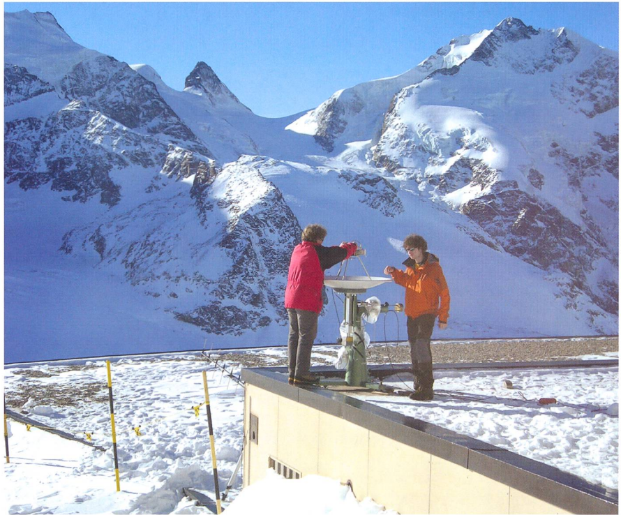
^ Studenten bereiten den 1m-Spiegel vor für eine Messung des neutralen Wasserstoffs. Im Hintergrund die markanten Berge Crast Agüzza und Piz Bernina.
