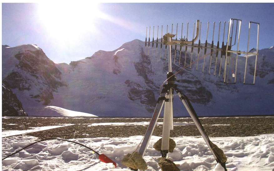
Westantenne des Radio-Interferometers im Dezimeterwellengebiet. Die Antenne ist auf den Meridiandurchgang der Sonne ausgerichtet. Im Hintergrund, rechts unterhalb der Sonne der bekannte Berg Piz Palü.
