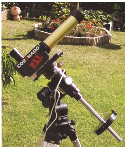
Fig. 4: Le PST fixé sur une monture équatoriale. (Photos: Grégory Giuliani)
