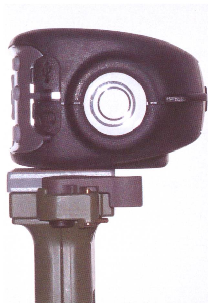
Le viseur du SkyScout avec ses deux cercles (mal) alignés. On voit également les couvercles pour la prise USB de connexion à l'ordinateur et la prise de l'écouteur. L'ordinateur n'est requis que pour effectuer une mise à jour éventuelle du SkyScout. (photo: Robert Rivoir)
