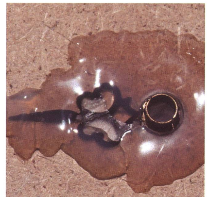
Der Stundenzeiger wird auf der Hinterseite des Sternenfeldes genau beim Himmelspol angeklebt. (Foto: Thomas Knoblauch)
