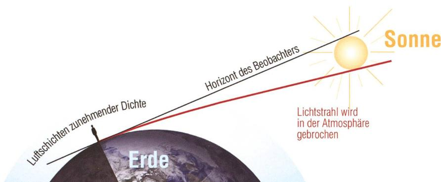
Abb. 1: Durch die zunehmende Dichte der Erdatmosphäre gegen die Oberfläche hin, wird ein Sonnenstrahl gebrochen. Steht die Sonne geometrisch betrachtet bereits unter dem Horizont, können wir sie infolge der Refraktion in der Tat noch etwas länger sehen. (Grafik: Thomas Baer)
