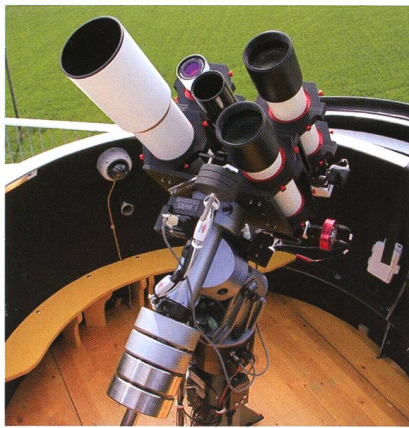
Abbildung 5: Der TeleVue NP-101 Refraktor mit fernsteuerbarem Optec TCF-S Okularauszug auf der deutschen 10micron GM2000 Montierung des Sonnenturms Uecht in Niedermuhlern (rechts unten), ausgerüstet mit dem Lunt Ca II K Diagonal und der rotfarbenen monochromen Atik 320e CCD Kamera. (Teleskop rechts unten)
