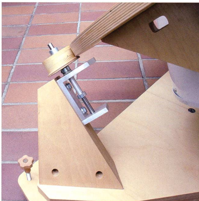
Abbildung 7: Tubus mit Gegengewicht, Südlager und Feineinstellung für Azimut und Höhe.
