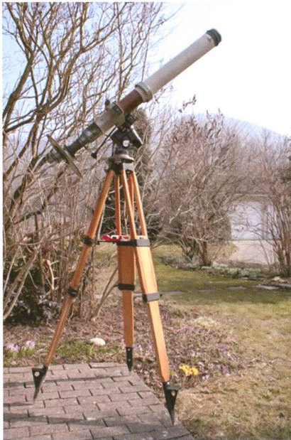
Abbildung 2: Der seit 1855 zur täglichen Bestimmung der Sonnenfleckenrelativzahl benutzte 83/1300 mm-Fraunhoferrefraktor von RUDOLF WOLF. Implizite wurden und werden alle zur Messung der langfristigen Veränderungen des Sonnenklimas genutzten Zählungen von Gruppen und Einzelflecken auf dieses Instrument geeicht. Seit 1996 werden die Standardbeobachtungen im Auftrag der RUDOLF WOLF Gesellschaft von Dr. THOMAS K. FRIEDLI durchgeführt.
