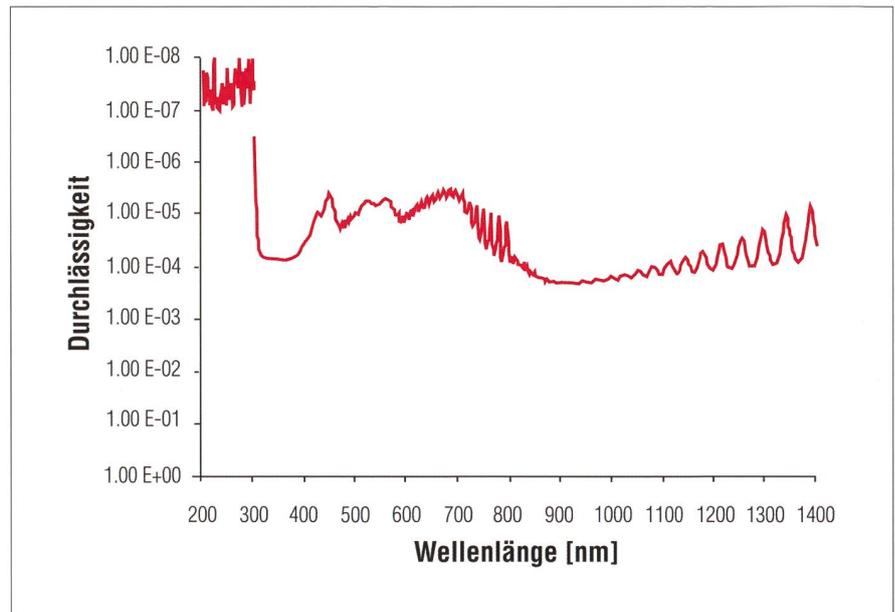
Abbildung 3: Transmission einer zertifizierten AstroSolar Filterfolie der Dichte 5 von Baader Planetarium. Im UV um 200 nm Wellenlänge ist die Folie praktisch undurchsichtig, während sie im IR um 900 nm Wellenlänge relativ am durchlässigsten ist. Für die fotografische Arbeit ist auch eine Folie mit Dichte 3.6 erhältlich. (Grafik: Thomas Baer nach Thomas K. Friedli)
