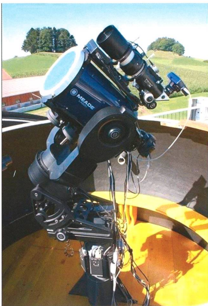
Abbildung 4: Ein fotografischer Objektivfolienfilter der Dichte 3.6 von Baader Planetarium, montiert in einer Fassung von Kendrick am 8" LX200 ACF des Sonnenturms Uecht in Niedermuhlern. (Foto: Thomas K. Friedli)
