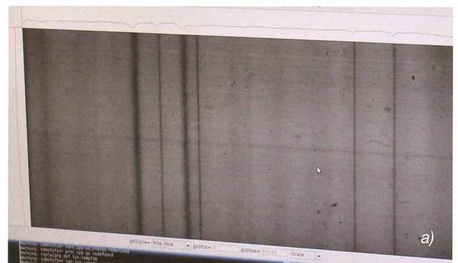
Abbildung 4a: Bildschirmaufnahme der Eisenlinien um 6302 \text{ \AA} in einem fleckenfreien Bereich der Sonne.
