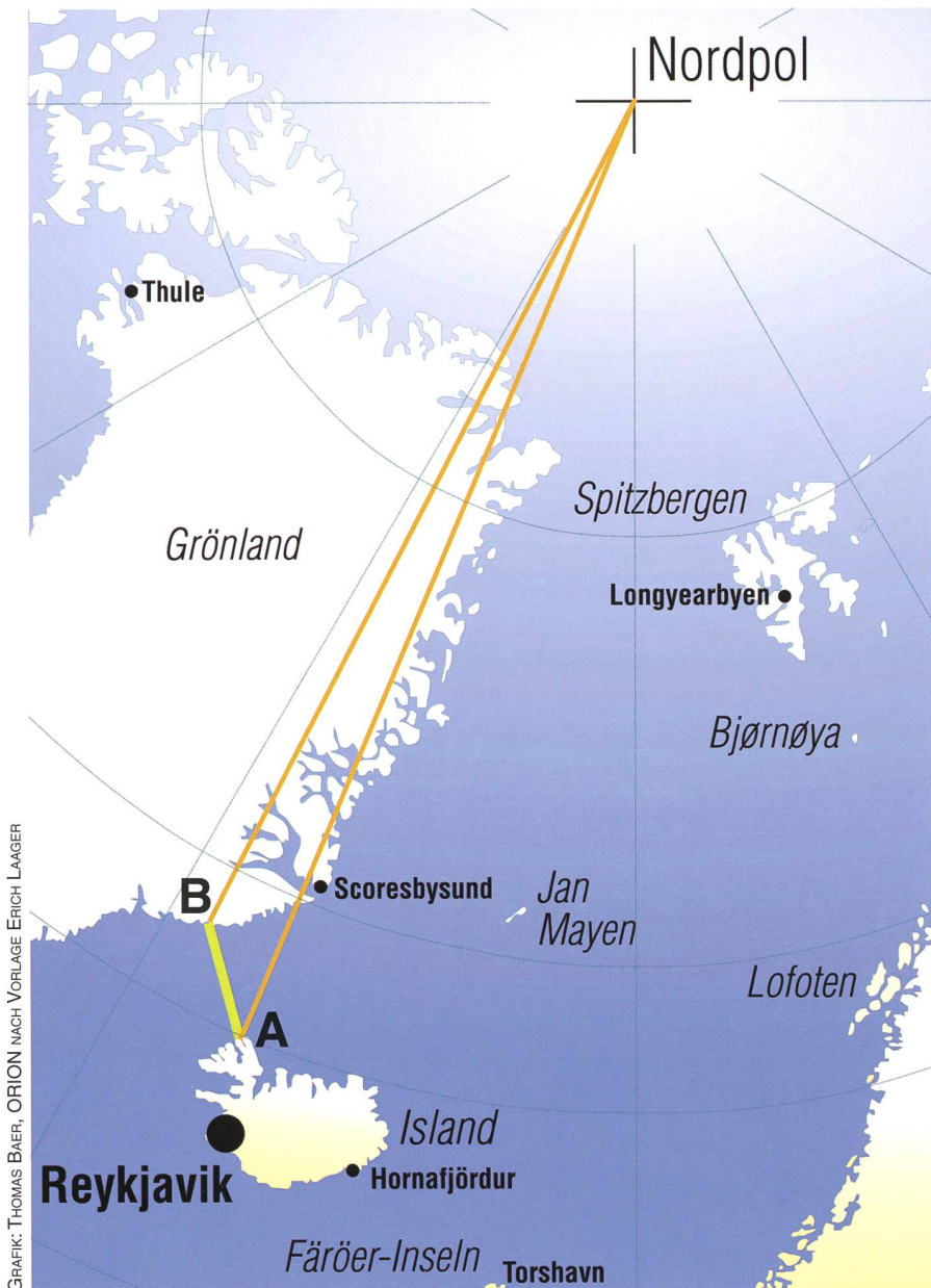
Abbildung 1: Sphärisches Dreieck (Kugeldreieck) zum Berechnen der Distanz von Island nach Grönland. Die geogr. Koordinaten der Punkte an den Küsten liefern zwei Dreieckseiten, die vom Nordpol aus gehen und den zwischen ihnen liegenden Winkel. Daraus lässt sich die dritte Seite berechnen. Dies ist die gesuchte Distanz.
