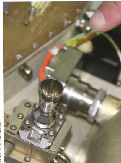
Abbildung 2: Das trichterförmige Triebwerk stösst Stickstoff aus und liefert den Niederhalteschub.
