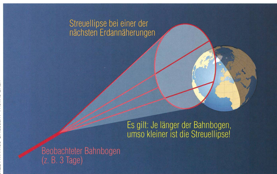
Abbildung 3: Zur Ermittlung von Impakt-Risiken wird der eben bestimmte Bahnbogen eines erdnahen Asteroiden in die Zukunft verlängert, wobei die möglichen Abweichungen berücksichtigt werden. Es entsteht so eine Streuellipse, die bei einem nur kurzen Bahnbogen deutlich grösser ist, als wenn eine längere und entsprechend auch genauere Bahn vorliegt. Mit mathematischen Modellen suchen nun die Bahnspezialisten von Sentry und NEODyS unabhängig voneinander nach Situationen, in denen diese Streuellipse mit unserer Erdkugel eine Deckung hat, wobei in der Regel ein Zeithorizont bis maximal 100 Jahre untersucht wird.
