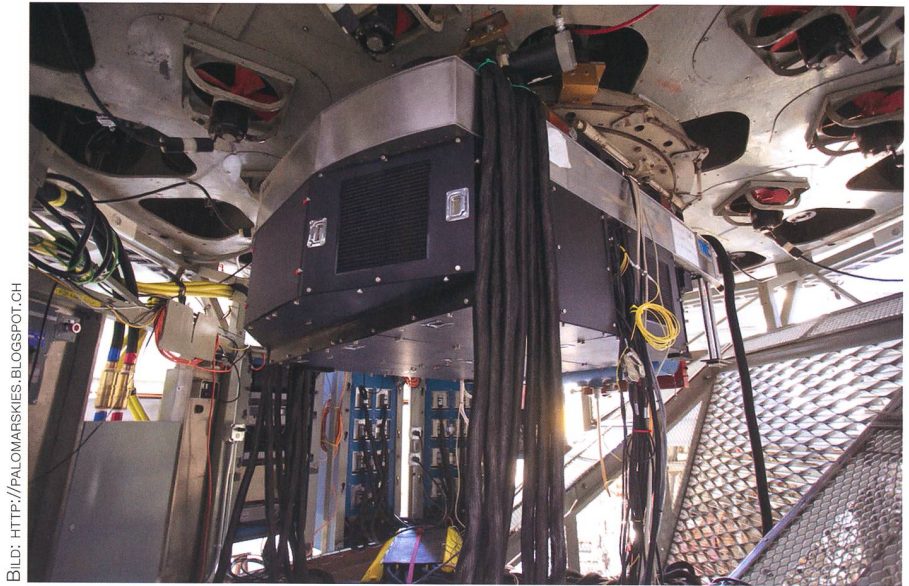
Abbildung 7: PALM-3000, die adaptive Optik, die wie eine variable Brille unter dem Hauptspiegel des Hale-Teleskopes montiert worden ist. Das Gerät kann die atmosphärischen Störungen zu einem enorm hohen Teil ausgleichen. Dafür sorgen 3'388 kleine «Aktuatoren», die einen plastischen Spiegel ständig neu verformen. Es soll u. a. für die Jagd nach extrasolaren Planeten eingesetzt werden.
