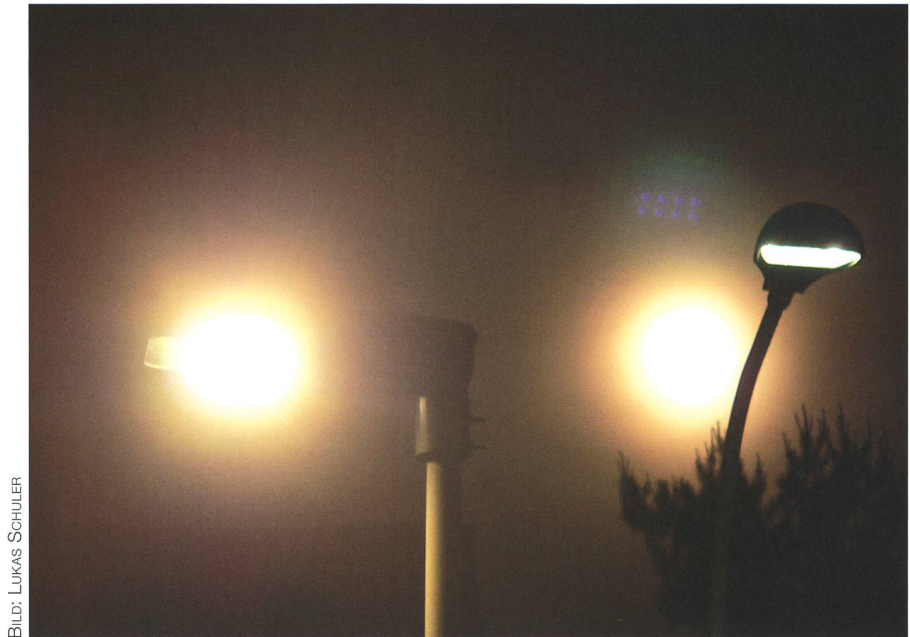
Abbildung 2: LED-Strassenlampen und Vollmond (10. Mai 2017, 21:14 Uhr). V. l. n. r. 4000 Kelvin LED-Strassenlampe (Jg. 2017, Wohnstrasse, für Spektrum siehe Bild 1), aufgehender Vollmond, 5700 Kelvin LED-Strassenlampe (Jg. 2011, Quartierstrasse). Deutlich sichtbare Ähnlichkeit der Lichtfarbe von neuer Strassenlampe und Vollmond. Der Blauanteil der älteren LED rechts ist höher und beträgt 25.8 %.
