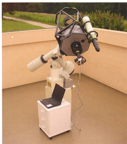
Abbildung 2: Über Jahre hinweg war der 40 cm / f5.9-Hypergraph auf einer älteren Alt-Montierung das Arbeitspferd in der Sternwarte Eschenberg.
