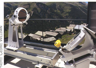
Photo 4 : Cœlostat fourni par l'Observatoire de Paris.
