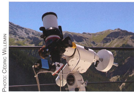
Photo 5 : Lunette Lunt de 60mm montée sur une monture équatoriale Sky Watcher HEQ5 Pro, équipement permettant d'observer le Soleil en lumière monochromatique, dévoilant protubérances et autres structures.
