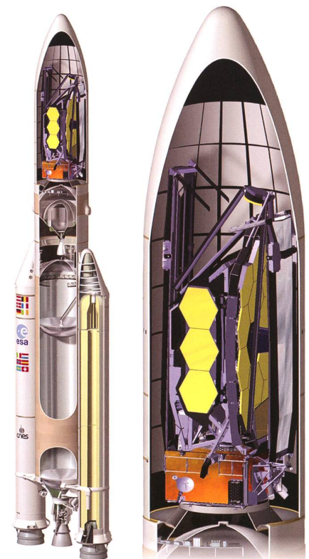
Abbildung 6: Das James Webb-Teleskop, respektive der Hauptspiegel, müssen für den Transport in der Ariane-5-Rakete zusammengefasst werden und in der Zeit, solange es auf dem Weg zum Beobachtungsort ist, in vielen Teilschritten wieder entfaltet werden.
