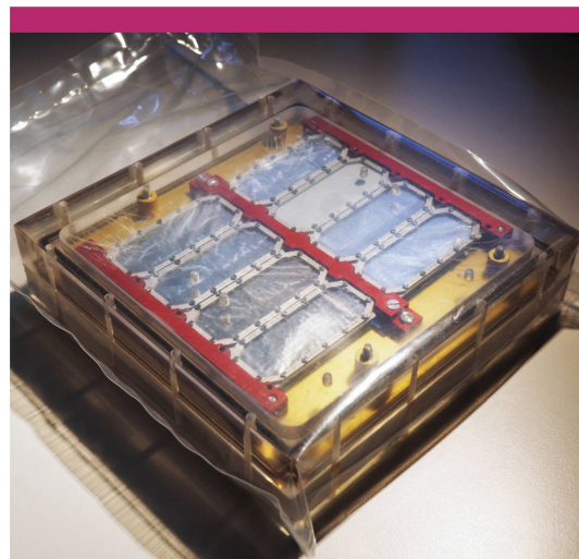
Abbildung 2: Die originalen Folien der Universität Bern, die auf der Raumstation Skylab waren, sind für die Auswertungen in kleine Metallrahmen gespannt worden. Sie sind nach wie vor in einen Plastikbeutel eingeschweisst, um eine Kontamination zu vermeiden.
