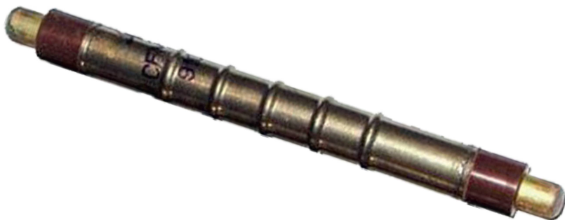
Abbildung 3: Geiger-Müller-Zählrohr SBM-20 aus früherer sowjetischer Produktion.
