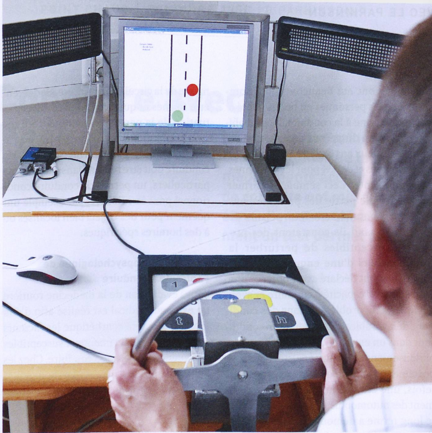
Système de test pour l'examen d'aptitude à la conduite : il convient de respecter la voie de circulation tout en évitant les éventuelles collisions. Photo : Kurt Heuberger
