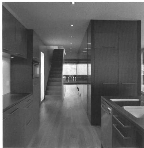
Fig. 17 Le local WC et l'agencement de la cuisine, comme les armoires de rangement, sont posés dans l'espace, détachés de l'enveloppe, de manière à conserver le caractère ouvert de l'espace de l'ancien fenil.
