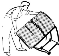
Dank der Abwälzkufen wird das Faß mit Leichtigkeit aufgebockt
