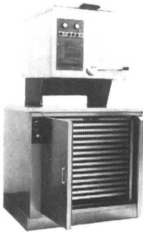
Abbildung zeigt 60 Liter Rührwerk mit Wärmeschrank
