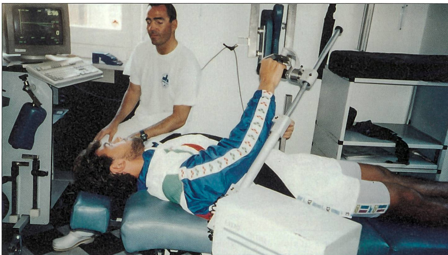
Fig. 4: Valutazione isocinetica con Lido Active (Loredan, Ca., U.S.A.); il movimento combinato di flessione-abduzione e estensione-adduzione, qui illustrato, è da noi impiegato oltre a quello di rotazione interna ed esterna, per valutare l'equilibrio muscolare e la forza dell'arto superiore.
