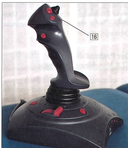
Abb. 9: Mit dem Joystick [16] wird die SLR-Maschine gesteuert: Drückt der Proband den Hebel nach rechts, bewegt sich die SLR-Maschine aufwärts, in Mittelposition bleibt sie stehen und nach links bewegt sich die Maschine abwärts.
