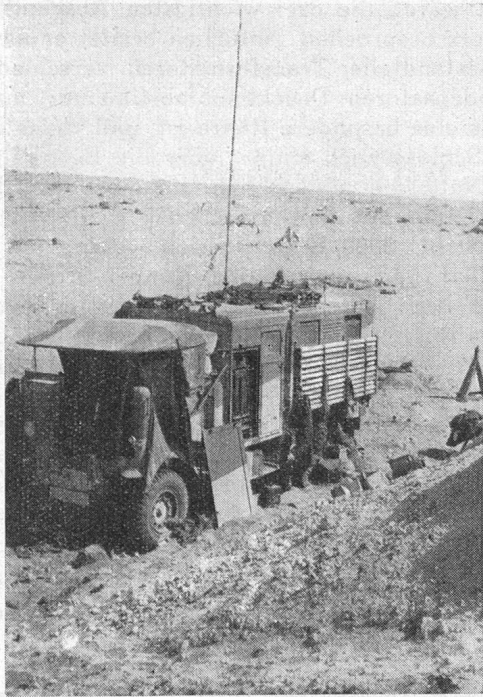
Kgl. englisches Korps der Uebermittlungstruppen. Unentbehrlich für die Kriegführung in ausgedehnten Gebieten ist die fahrbare Funkstation. Der abgebildete Wagen hat eine «Reichweite» von mehr als 1000 Meilen und vermag Morse- wie auch Telephon-Meldungen aufzunehmen.
