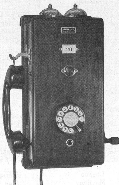
Abb. 1. Selektor-Telephonapparat für dezentralisierte Wechselstromwahl.
