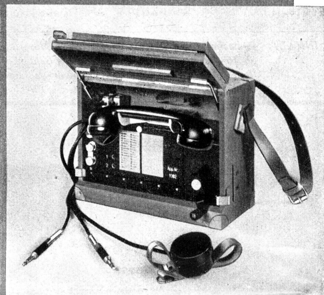
Tragbares Feldtelefon zum Anschluß an Orts- oder Zentralbatterie-Zentralen und an das autom. Telefonnetz.
