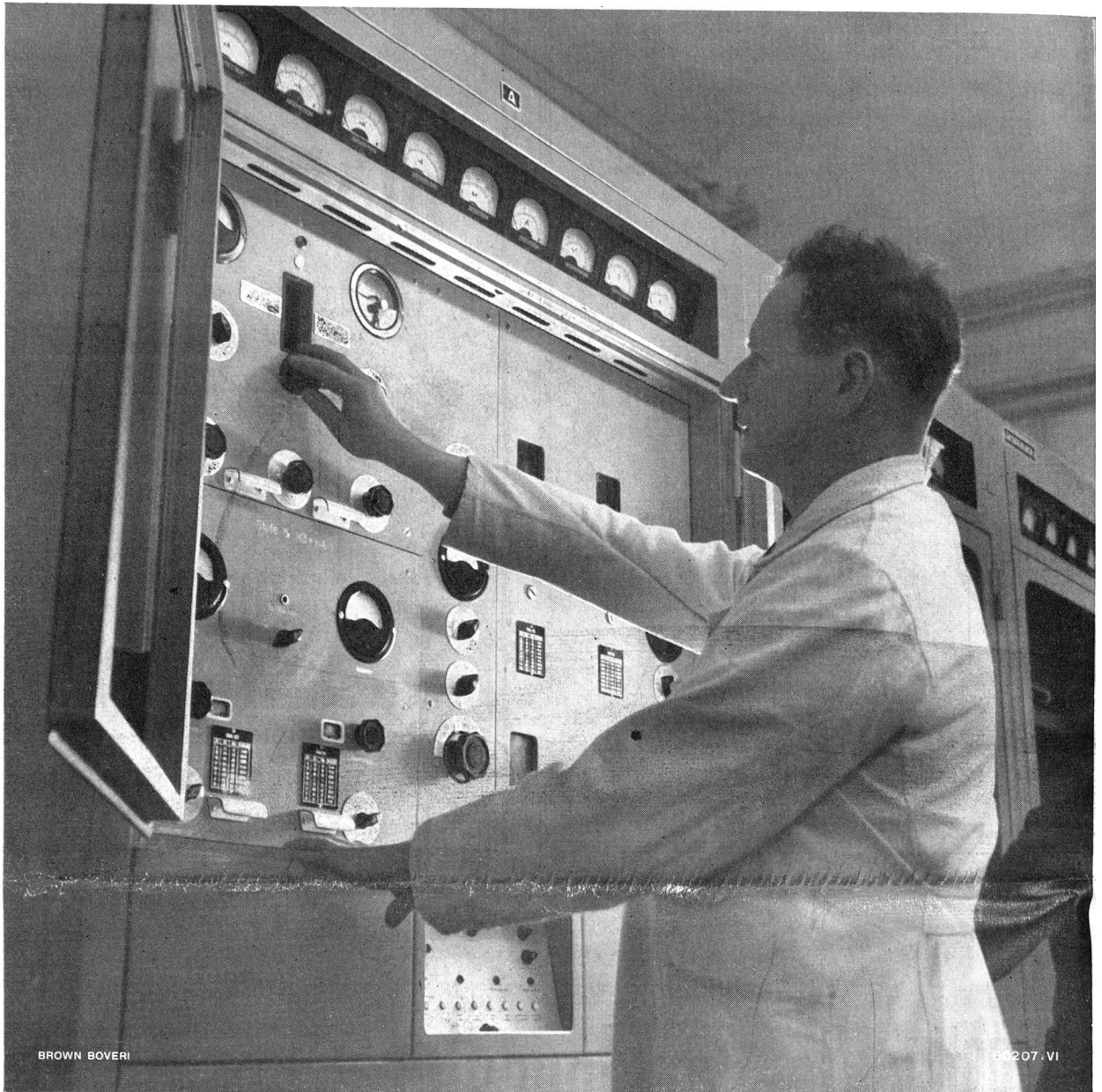
Abstimmung eines Kurzwellensenders
