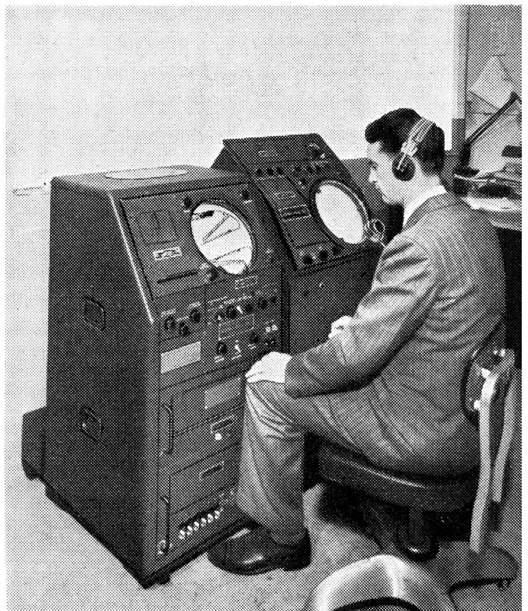
Abb. 5. GCA-Radar-Konsolen, von welchen aus der Kontrolleur das ganze System steuern und den gesamten Nahzonen- und Landeverkehr mittels Radio-Telephonie dirigieren kann. Diese Geräte wurden von der Gilfillan Bros. Inc., Los Angeles, konstruiert und hergestellt. Die rechte Konsole enthält das PPI-Anzeigergerät und die linke den „Az-el“-Schirm. Die Konsole der beschriebenen Modell 8-A-Anlage enthält zwei „Az-el“-Schirme für zwei verschiedene Distanzbereiche. Werkphoto Gilfillan Bros.
