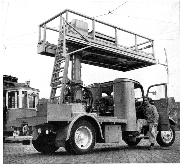
Vollautomatische Radiovoxanlage der Industriellen Betriebe der Stadt Zürich Turmsägen der VRZ. Antennenmast auf der Kabine, Apparatur an der Rückwand und Sprechstelle am Armaturenbrett.
