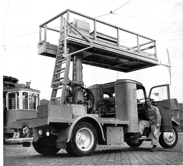
Vollautomatische Radiovoxanlage der Industriellen Betriebe der Stadt Zürich Turmsägen der VRZ. Antennenstab auf der Kabine, Apparatur an der Rückwand und Sprechstelle am Armaturenbrett.
