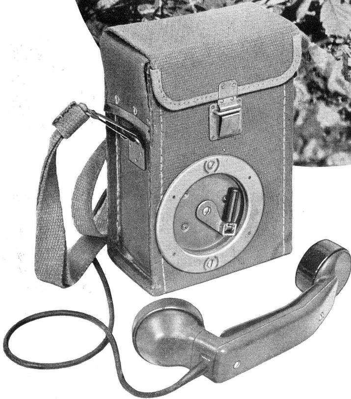
*Die neue Albis-Feldstation FTf 50 weist eine Reihe von Verbesserungen und Neuerungen auf. Durch die kleinen äusseren Abmessungen und das geringe Gewicht lässt sich diese Station gut tragen. Die verbesserten Uebertragungseigenschaften erleichtern die Verständlichkeit bei Lärm und Wind.*
