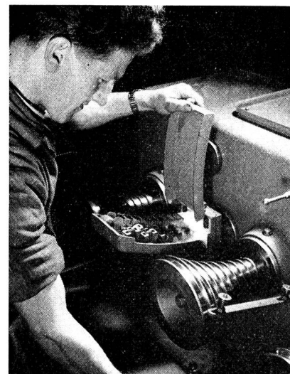
Das Verfeinern des Kupferdrahtes auf immer dünnere Drahtdurchmesser erfolgt in modernen Ziehmaschinen. Das Bild illustriert eine Feindrahtzieh-anlage, bei welcher der Kupferdraht durch kalibrierte Industriediamanten bis zu einem Drahtdurchmesser von 0,025 mm gezogen werden kann.
