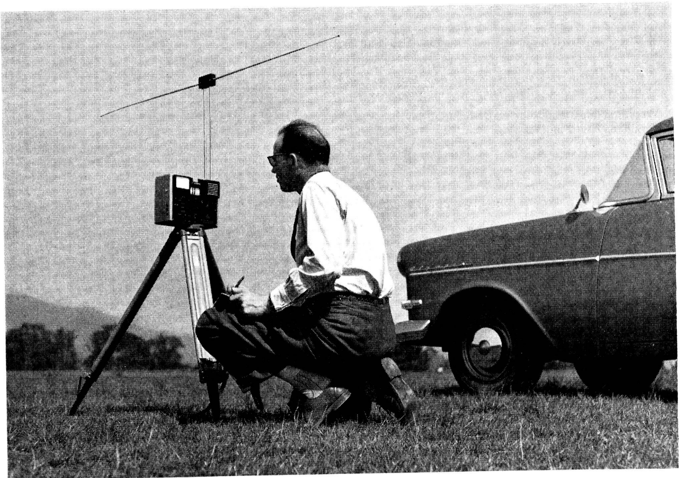
Kontrolle des Störvermögens eines Motorfahrzeuges mit dem Feldstärke-Messgerät.
