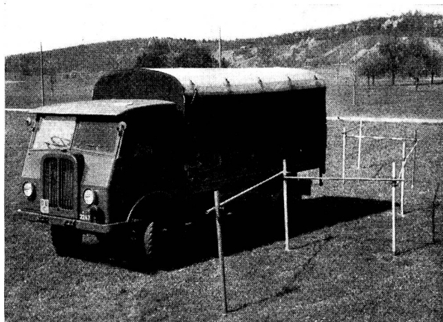
Zu Beginn der Fahrausbildung erhält der Motorfahrer Gelegenheit, sich mit den Dimensionen und den Fahreigenschaften der verschiedenen Fahrzeugtypen auseinanderzusetzen. Ein System von Pfählen und Röhren, das sogenannte «Fahrschul-Meccano», ermöglicht das rasche Aufstellen von verschiedenartigen und ungefährlichen Abschränkungen.
