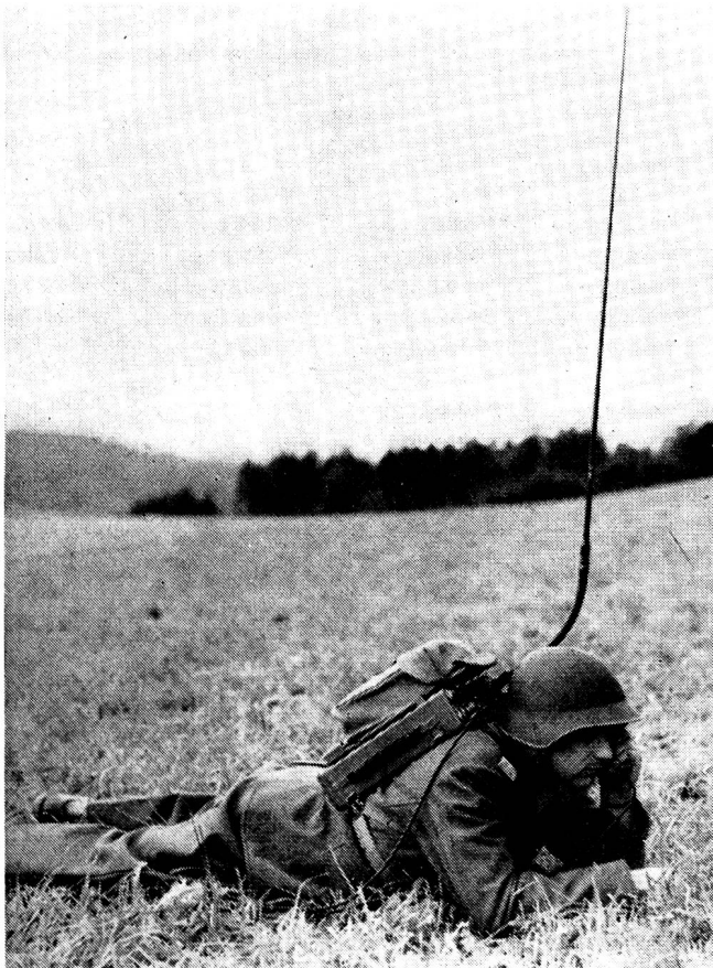
Abb. 6 Kleinfunkstation SE-206/207 als Tornistergerät im Einsatz.
