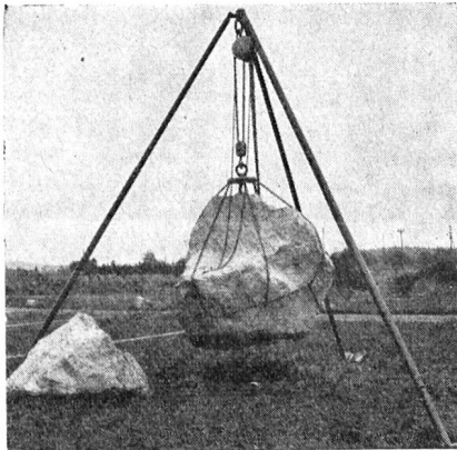
Mod. A: mit 3 teleskopisch verstellbaren Stahlrohrstützen.
