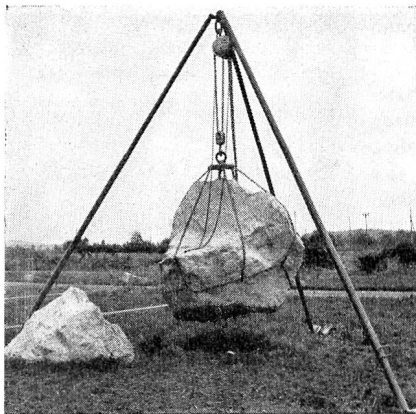
Mod. A: mit 3 teleskopisch verstellbaren Stahlrohrstützen.
